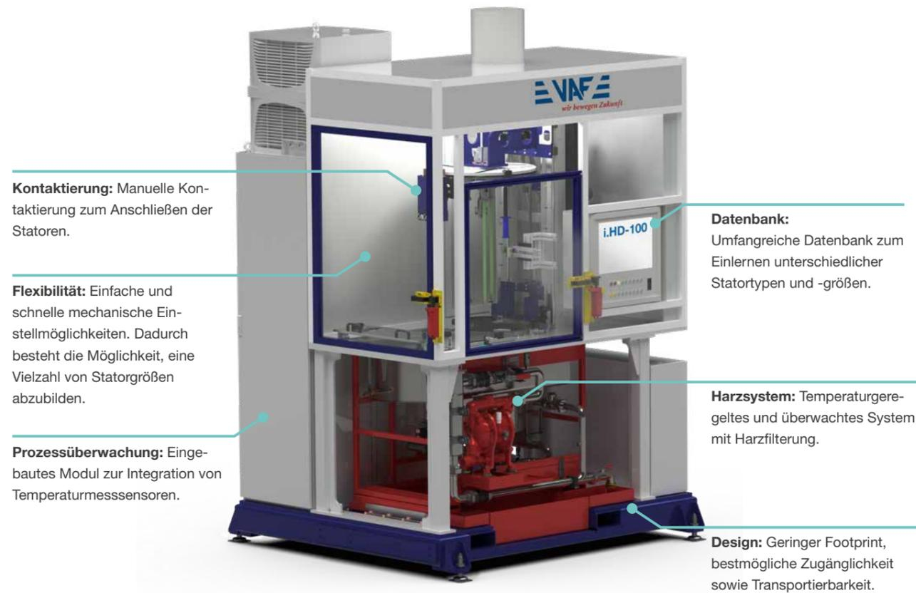
Die i.HD-100 ist optimal für den Einsatz in einer Testumgebung oder für die Kleinserienproduktion geeignet.
