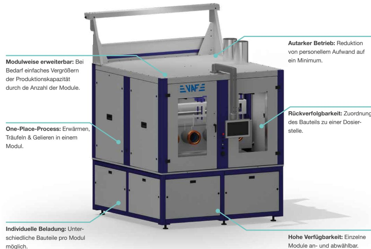
Der komplette Imprägnierprozess wird an einer Position abgebildet (One-Place-Process). Dies ermöglicht eine hochflexible Prozessgestaltung, da kein Weitertakten erforderlich ist. Umspannen und Unregelmäßigkeiten in der Drehbewegung werden vermieden, was zu einer hohen und konstanten Qualität der Bauteile führt.
