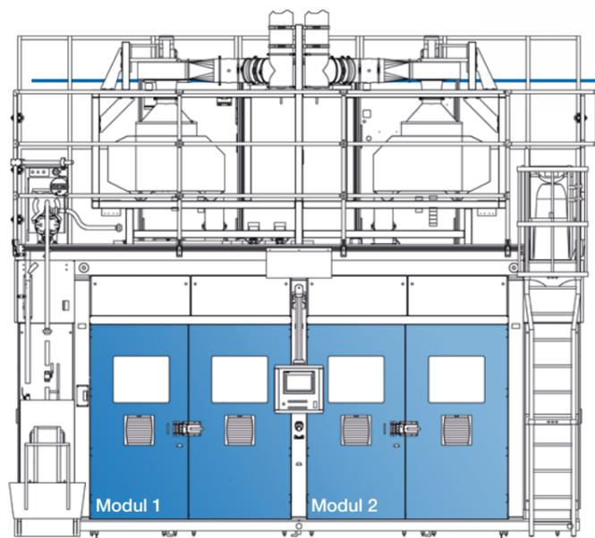
Durch den geteilten Anlagenaufbau kann modulunabhängig produziert werden. Die Prozessaufteilung führt zu einer optimalen Auslastung der Anlage. Wartungsfreundlichkeit sowie Energieeffizienz sind mit einer perfekten Imprägnierqualität vereinheitlicht.
