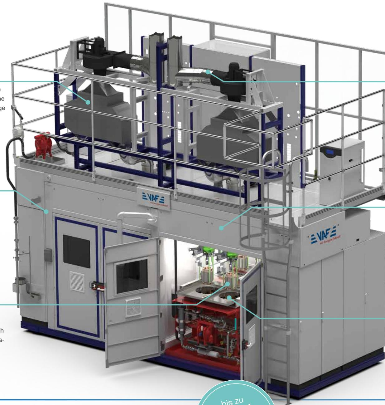
**Anlagendesign:** Durch den modularen Anlagenaufbau können unterschiedliche Stator Typen gleichzeitig mit einer Anlage imprägniert werden.
